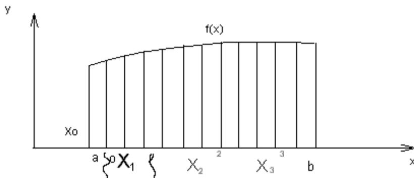
Определим площадь криволинейной трапеции – фигуры, ограниченной прямыми  $x=a, x=b, y=0$  и графиком функции  $y=f(x)$
