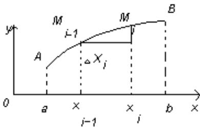
а) Пусть кривая задана уравнением  $y = f(x)$ . Возьмем на  $\overset{\cup}{AB}$  точки  $A, M_1, M_2, \dots, M_i, B$ , и проведем хорды, которые обозначим  $\Delta l_1, \Delta l_2, \dots, \Delta l_n$ . Получим ломанную  $AM_1 \dots M_{n-1} \dots B$ , вписанную в дугу  $AB$ . Длина ломаной:  $l_n = \sum_{i=1}^n \Delta l_i$ . Длина
